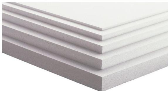
lajes de concreto resistente, com um valor de 4,5 MPa de resistência à flexão/tracção, que assentam directamente sobre aqueles blocos. A **base em E.P.S.** substitui a base (aterro e solos seleccionados e inertes compactados) e sub base (em concreto pobre de 100 kg), mantendo ao longo do tempo todas as suas características. A base em E.P.S. terá as dimensões que resultarem
