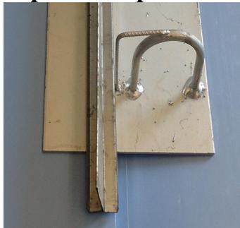
O **indutor de junta**, executado em chapa de aço zincado, é colocado sobre as chapas de aço de forma a assegurar a localização exacta da junta, e em simultâneo impedir a infiltração de líquidos para a base, encaminhando-os para o sistema de drenagem do pavimento. O fenómeno de “pumping” é assim eliminado, e a base fica protegida contra eventuais infiltrações de contaminantes.
