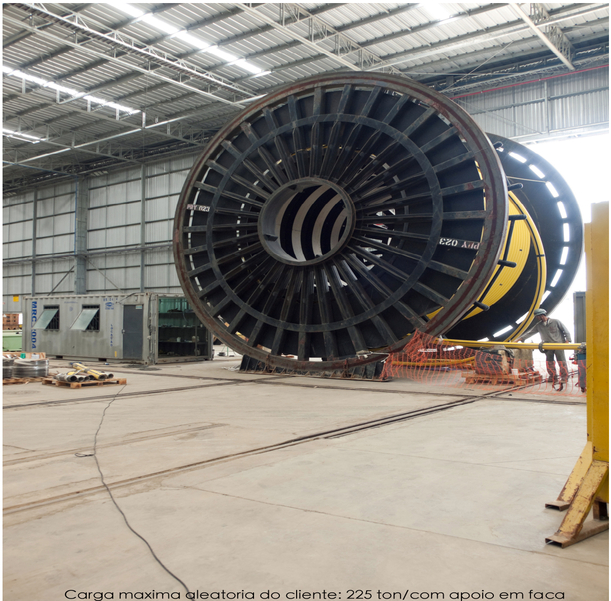
Apoio em faca/em forma de caril
